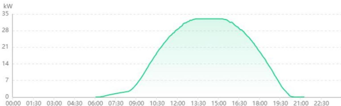
Die Stromproduktion der Anlage übertrifft dank der idealen Wetterbedingungen die vormals berechneten Prognosewerte von 36'000 kWh pro Jahr deutlich, zumal erfahrungsgemäss 75% des Ertrags im Sommerhalbjahr von April bis September anfallen.
